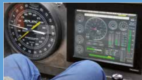
Suivi du train de forage (poids, profondeur...).
