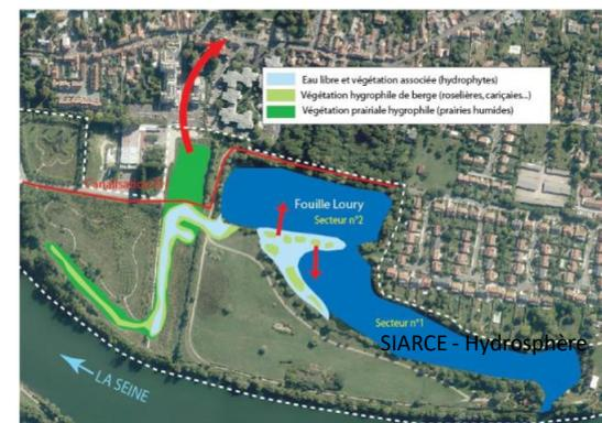
Figure 5 : Principe d'aménagement d'une annexe hydraulique en relation avec la foulle Loury – Scénario 1
